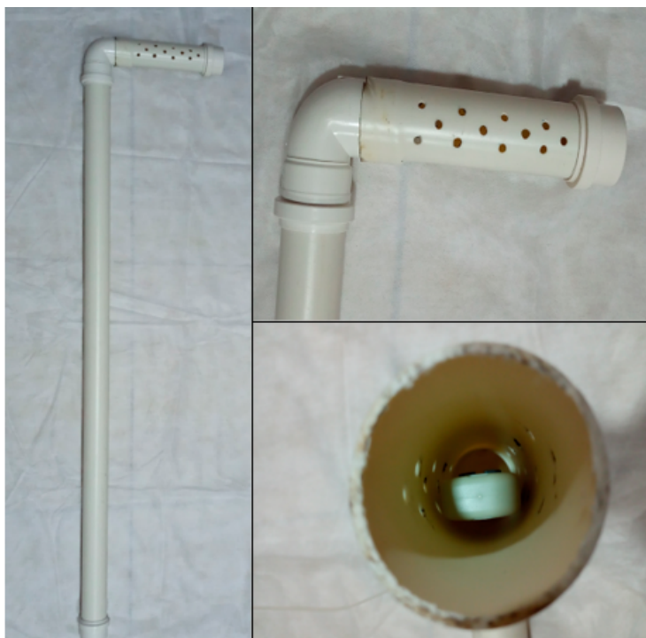
Figura 3 - Abrigo para o termo-higrômetro
