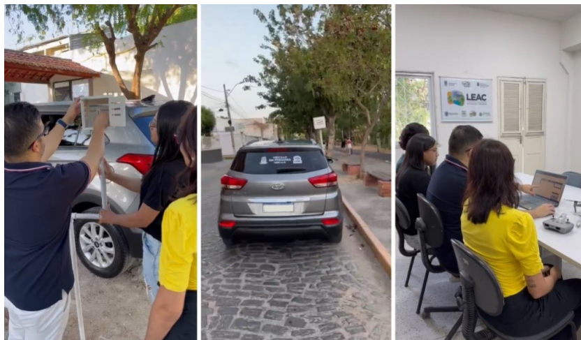
Figura 47 - Preparo dos dataloggers nos abrigos, realização de transecto móvel e tabulação/análise dos registros termohigrométricos, respectivamente
