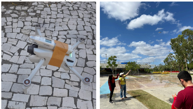
Figura 46 - Vista do Datalogger acoplado a um drone (por meio de fita adesiva) e em voo gerando dados dos parâmetros climáticos em sua dimensão vertical
