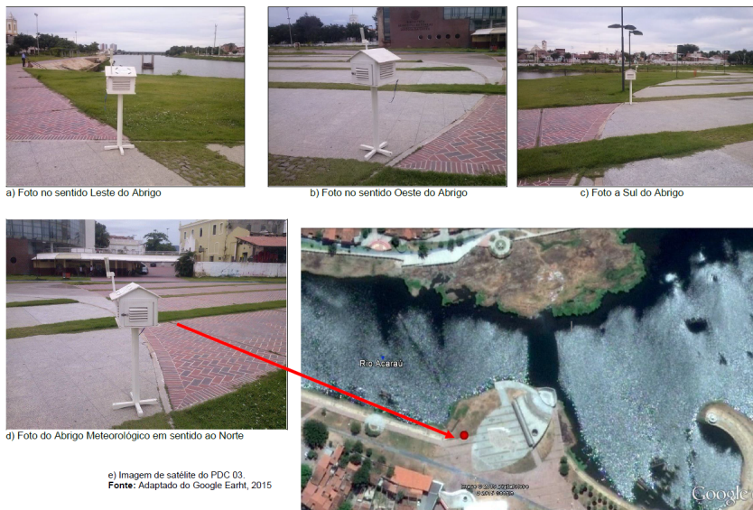
Figura 44 - Procedimentos técnicos de produção de dados primários na Margem Esquerda do Rio Acaraú, na cidade de Sobral CE), utilizando abrigo microclimático de madeira adaptado ao espaço urbano
