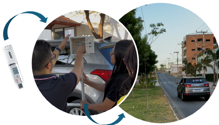
Figura 17 - Datalogger utilizado na aferição inserido em abrigo de madeira para realização de transecto móvel
